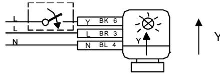
阀门通过执行器以电动方式打开。该设备中集成了同步电机和齿轮机构。最大行程通过机械方式进行限制（阀座）。末端位置无电力消耗。带有 1.5 m 长的电线连接，电线是执行器组成部分。
