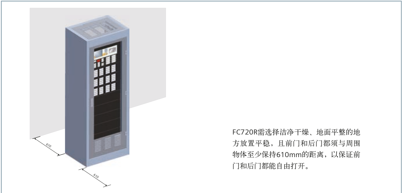
图3-5 安装位置示意图（单位：mm）
